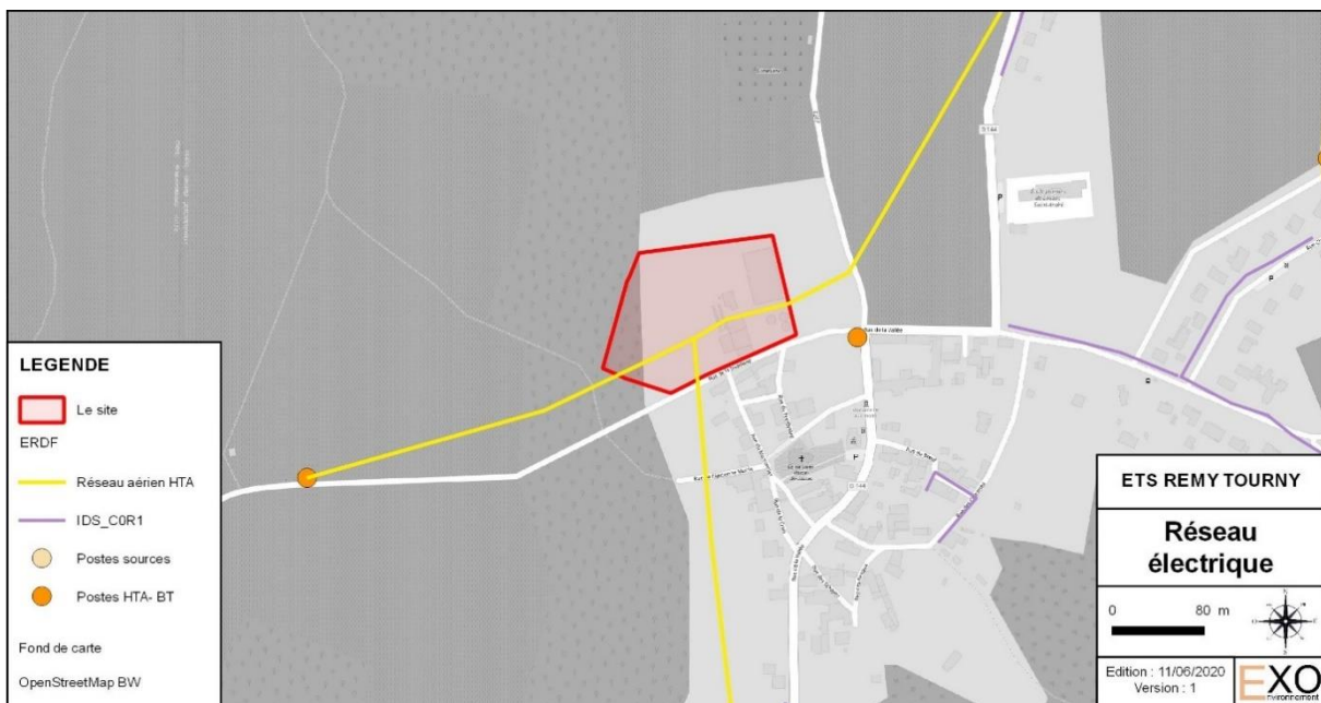
Figure 7 : Réseau électrique à proximité du site
